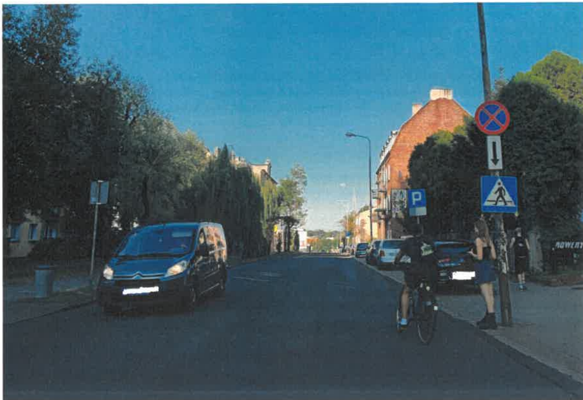
Przejście dla pieszych ul. Legionów, bez oznakowania poziomego
