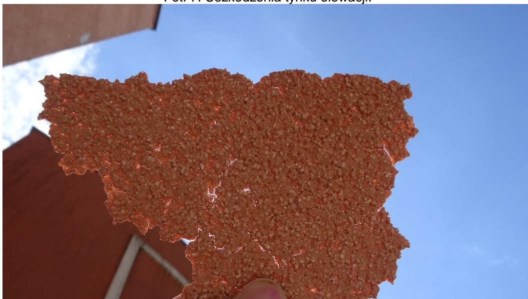
Fot. 8. Odspojony tynk.
