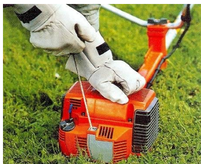
Rys.2 Dopuszczalne sposoby uruchamiania pilarki z urządzeniem tnącym na wysięgniku
